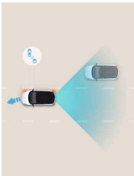
Sistem de asistență la evitarea coliziunii din unghiul mort (BCA)
